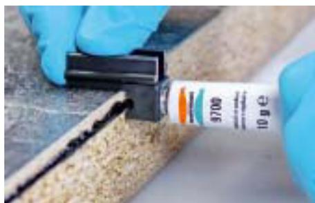
**2/** Kein Abfließen an senkrechten Flächen: Membranverschluss durchstoßen, Applikationshilfe aufschrauben und an der Kante entlangführen. Die Hohlkehle sorgt beim Auftragen für die richtige Dosierung.
