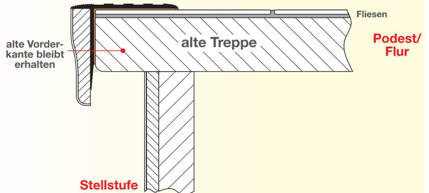
**Hinweis:** Der Übergang zwischen Austrittstufe und vorhandenem Bodenbelag kann mit HAFA-Aluminiumprofilen gestaltet werden.
